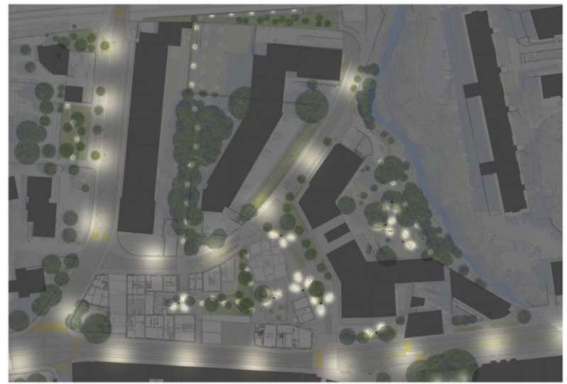
éclairage des places multi-projecteurs sur mât type BEGA hauteur des mâts 450 cm
